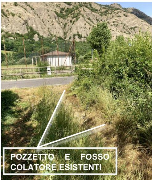
L'ultimo tratto che si collega al pozzetto esistente, per una lunghezza di 44,00m, sarà costituito dal tubo autoportante sormontato da una piccola canaletta in trenchmat (avente uno sviluppo, in sezione di 1,20m) che va a ripercorrere il fosso colatore attualmente esistente lungo la strada vicinale.
