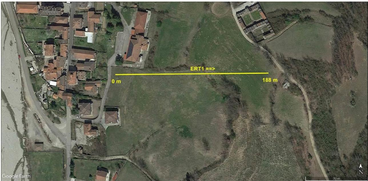
Il metodo di indagine è del tutto analogo a quello su cui si basa il tradizionale sondaggio elettrico verticale (SEV): immettendo nel terreno corrente continua (o corrente alternata a bassa frequenza) si genera un campo elettrico le cui linee di corrente all'interno del sottosuolo indagato sono deformate dalla presenza di disomogeneità, come a titolo di esempio stratificazioni o corpi sepolti aventi differenti comportamenti elettrici.
